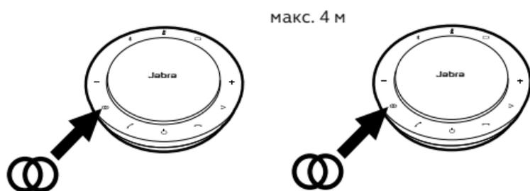
Чтобы прервать соединение спикерфонов, нажмите кнопку **Соединение** на одном из спикерфонов.
