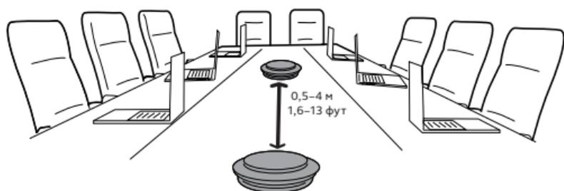
Для временного включения звуковой связи между двумя спикерфонами Jabra Speak 750 нажмите кнопку **Соединение** на обоих спикерфонах, если они находятся на расстоянии не более 4 м друг от друга.
