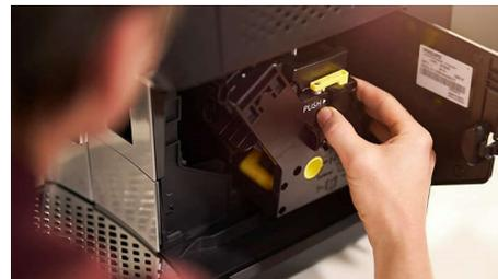
Варочная группа — это основной элемент любой автоматической кофемашины, который необходимо регулярно очищать. Съемную варочную группу можно тщательно очистить, просто сполоснув под струей воды.
