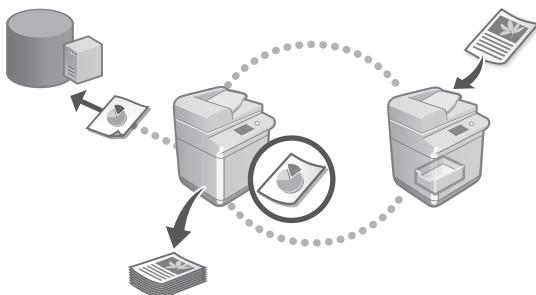
Sie können einen Windows Server oder den Erweiterten Platz eines anderen Canon Multifunktionsdruckers als Verbindungsziel speichern. Dadurch können Sie mit dem Gerät Daten ausdrucken, die sich auf dem Verbindungsziel befinden.
