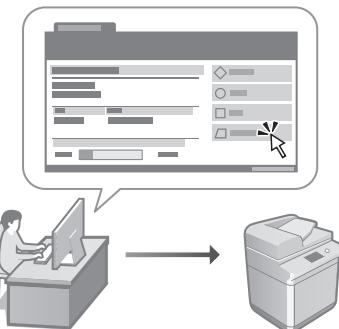
Con la IU remota, se puede gestionar este equipo desde un navegador web en un ordenador. Puede utilizarlo para consultar el estado operativo del equipo, cambiar ajustes y guardar elementos en la Libreta de direcciones.
