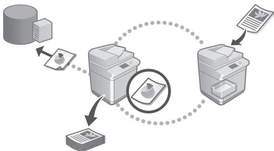
Puede registrar un servidor Windows o el espacio avanzado de otra impresora multifunción Canon como destino de conexión. Esto le permitirá usar el equipo para imprimir la información que se encuentren en la conexión de destino.
