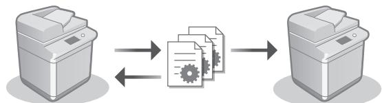
Puede guardar (exportar) los datos de configuración de otra impresora multifunción Canon en un ordenador. Luego puede importar los datos de configuración en el equipo para omitir el procedimiento de configuración.
