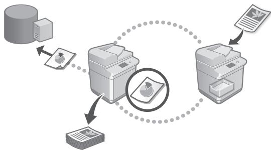
Vous pouvez enregistrer un serveur Windows ou l'espace avancée d'une autre imprimante multifonction Canon comme destination de connexion. Cela vous permet d'utiliser l'appareil pour imprimer des données stockées dans la destination de connexion.
