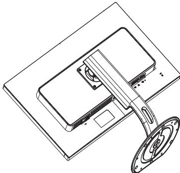
2. Открутите установочные винты, затем отсоедините ножку подставки от монитора.
